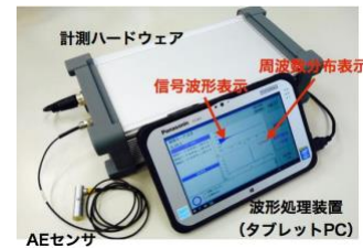
図-2 AE 打音検査装置の外観
