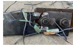
図 3-2 (1) SS-SS 破壊形態
