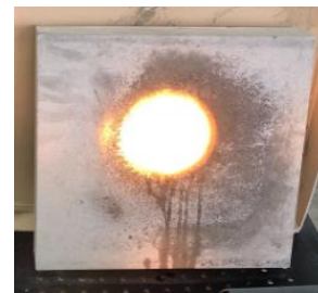
写真-2 塩水噴霧直後の試験体表面
