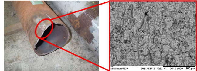
図4 破断した照明柱と破断面のSEM画像
