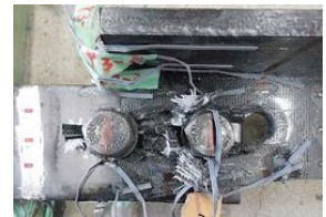
図 3-2 (2) FRP-SS 破壊形態
