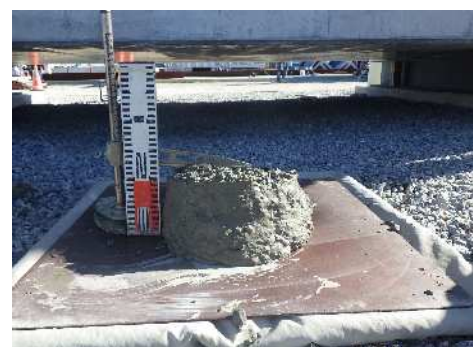
写真-4 コンクリートのフレッシュ性状 (ポンプ筒先排出後)
