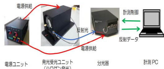
図-3 遠隔測定用のシステム構成 1)
