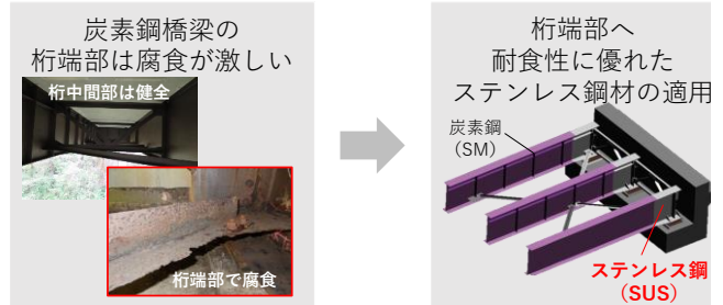
写真1 炭素鋼橋梁の桁端部
