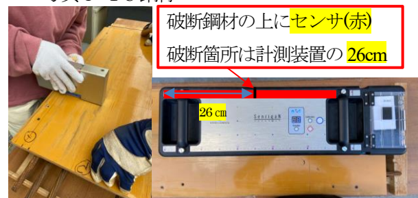
着磁の様子 (磁石ユニット) 計測の様子 (計測装置)
