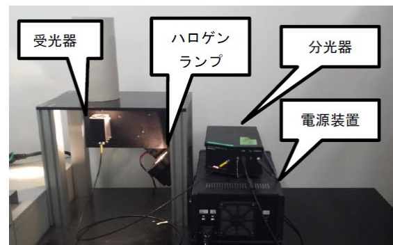
図-2 近接測定用のシステム構成 1)
