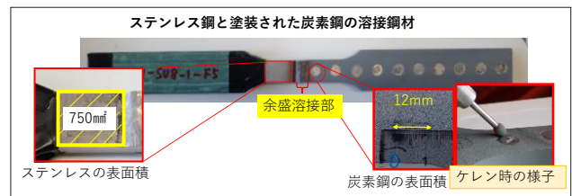
写真2 水浸試験で用いた試験体
