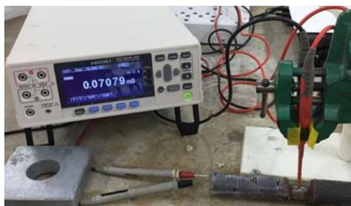
写真2 電気抵抗値の計測の様子
