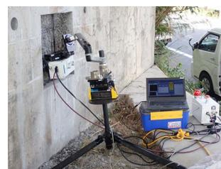
写真-1 X線回折法による筋残留応力測定
