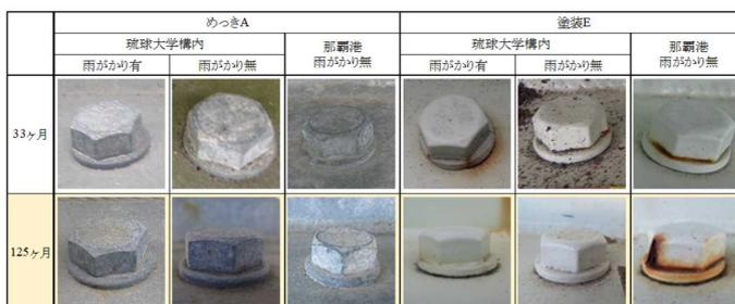
写真-8 めっき A 及び塗装 E のボルト頭部の錆進行
