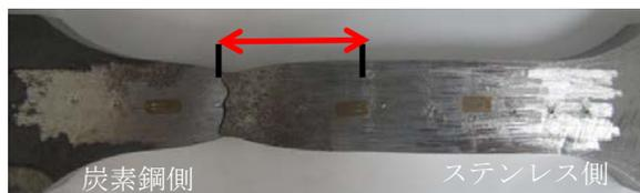
図 6 SM490-SUS821L1 材破断後
