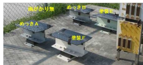
写真-2 海岸部試験体設置状況
