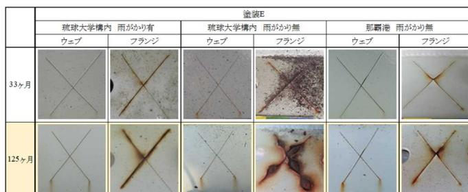
写真-7 塗装 E のクロスカット部の錆の進行状態
