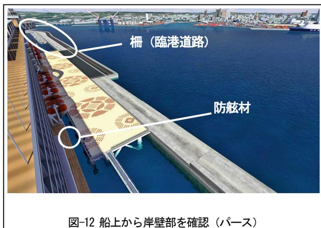
図-12 船上から岸壁部を確認 (パース)
