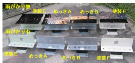
写真-1 内陸部試験体設置状況
