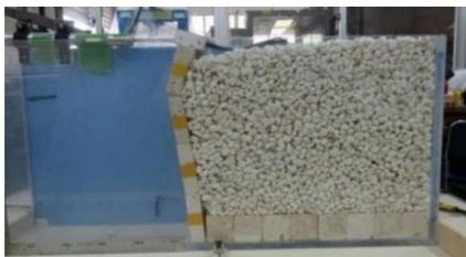
図4 擁壁崩壊の様子
