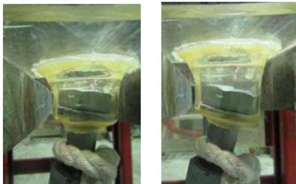
写真7 キャップの変形 (左, 載荷無し 右, 45 kg載荷)
