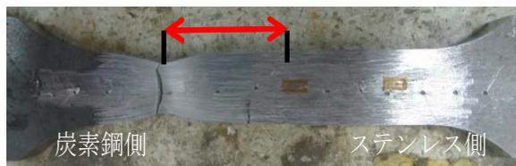
図 5 SM400-SUS304 材破断後
