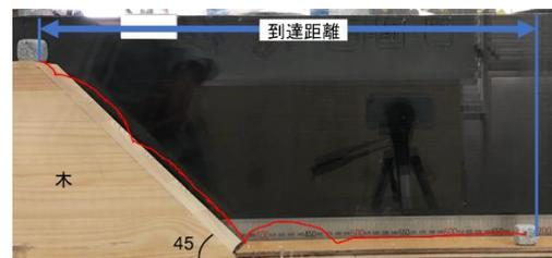
図-2 花崗岩ブロックの崩壊と到達距離の一例
