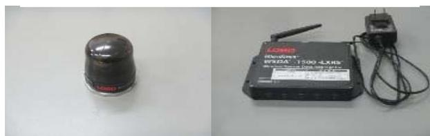
図3 使用機器〔左〕無線加速度センサ〔右〕親機〕
