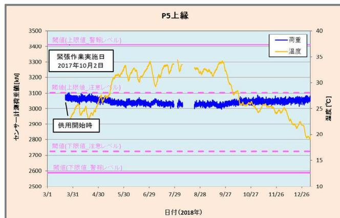
図-4 接合部 PC 鋼材の張力と温度の計測結果
