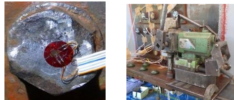
写真1.1 ひずみゲージ 写真1.2 コア抜き ひずみゲージ法による軸力解放時の様子
