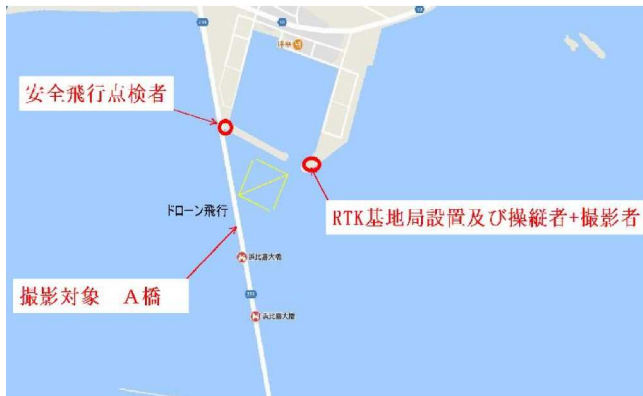
図-2 ドローン撮影の飛行ルート
