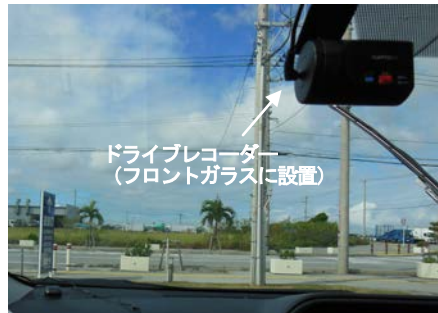
図-3 ドライブレコーダーの設置状況
