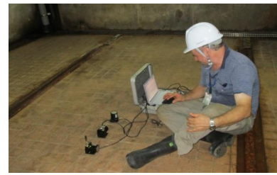
写真-4：B1Fにおける常時微動計測
