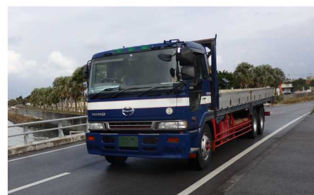
図 4 荷重車走行状況(荷重 10.1ton)
