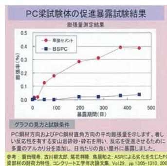
暴露試験体の膨張量測定結果
