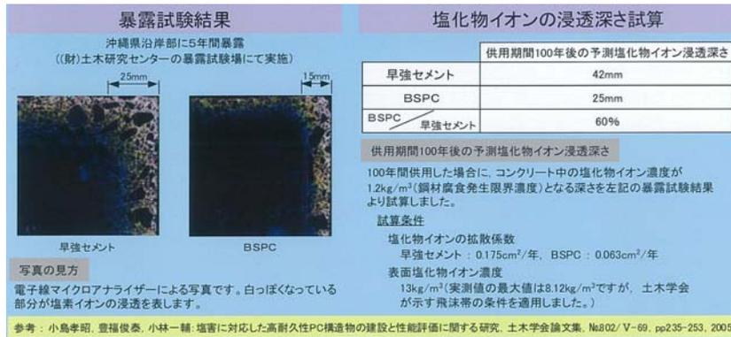
暴露試験結果と浸透深さの試算
