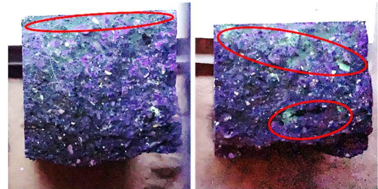
写真1 ASRゲルの発光状況(左:NC-10, 右:NC-15)
