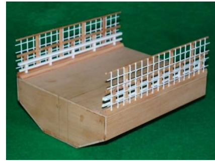
写真-1 小型風洞試験に使用した部分模型
