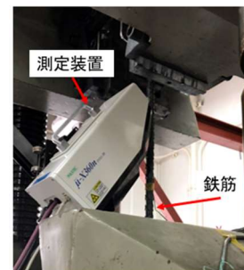
図-13 精度確認実験（引張試験）
