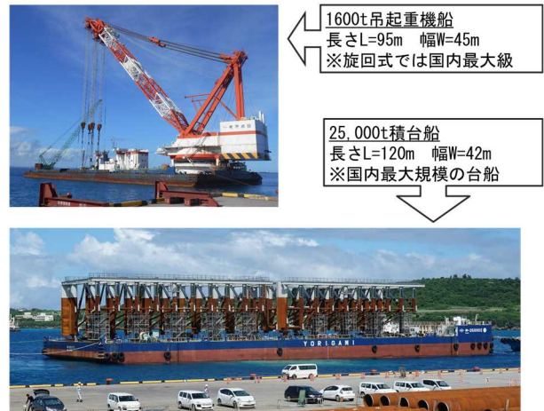
図7 ジャケット据付使用船舶
