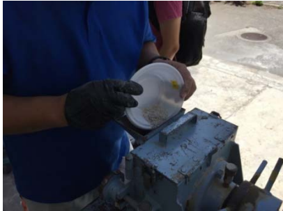
[写-2-3 粉砕機による作業状況]
