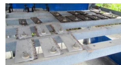
写真-3 那覇港暴露試験状況 左)雨がかりあり 右)雨がかりなし
