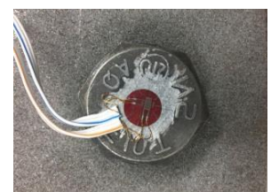
写真-6 ボルト頭部ひずみゲージ
