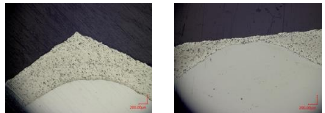
写真 - 4 重ね施工あり（左）重ね施工なし（右）
