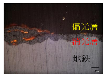
写真-8 30 年間暴露され実際に保護性錆を形成した耐候性鋼
