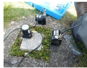
図-2 常時微動計測システム
