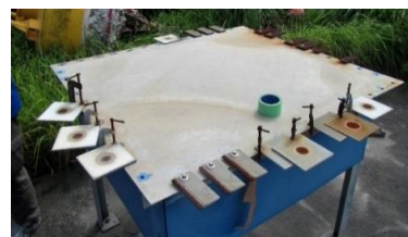
写真-3 那覇港暴露試験状況 左)雨がかりあり 右)雨がかりなし
