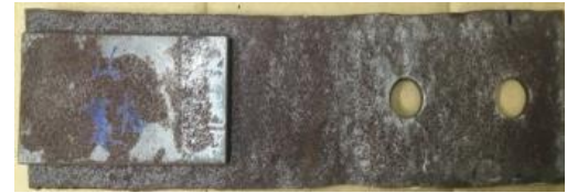
写真1: 腐食材の表面形状(試験体番号3)
