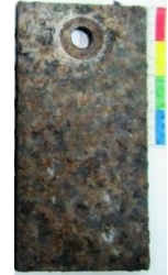
写真-4 琉大暴露場腐食外観状況 左)雨がかりあり 右)雨がかりなし
