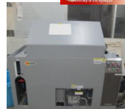
塩水噴霧試験 35°C、5%NaCl (PH7)
