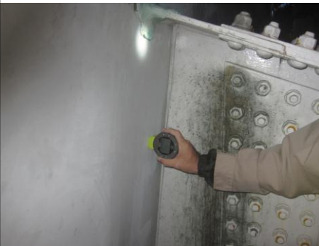
主桁ウェブの膜厚: 624 \mu m
