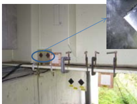
◆ガーゼ法による飛来塩分の測定(毎月)と鋼板ワッペンによる腐食減耗量を測定し腐食環境を判定
