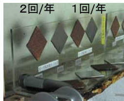
◆洗浄回数を鋼板の腐食速度から適切な回数を検討
