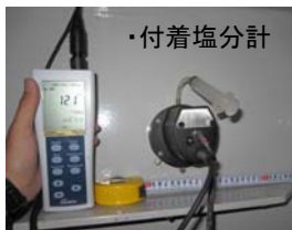
◆鋼桁に付着した塩分を測定
