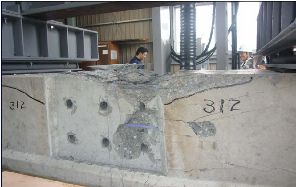
曲げ破壊試験 圧壊状況
